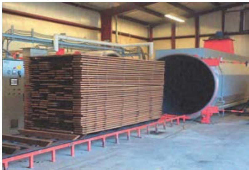
Figura 15. Fotografía de una cámara de tratamiento térmico 30 .
